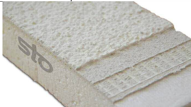
1. Opbouw: buitengevelisolatie afgewerkt met een kunstharsgebonden sierpleister (bijvoorbeeld in een korrelgrootte: 1, 1½, 2, 3 mm). Meest voorkomend is 1,5 en 2 mm.
